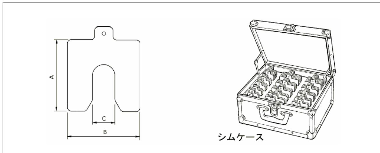
シム製品のラインナップは 5 種類あり、大抵の機械の土台に取り付けることができます。純ステンレス鋼製のシム、真鍮製又はステンレス鋼製の積層シムがあります。
